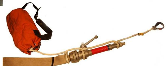
Abb. 4 Schlag am Strahlrohr
