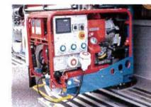
Erzeugt Strom zum Betrieb verschiedener Elektrogeräte
