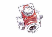
Das Druckbegrenzungsventil soll in einer Schlauchleitung den Betriebsdruck nach oben begrenzen. Wird der eingestellte Sollwert überschritten, so fließt ein Teil des Wassers aus dem Überlauf ins Freie
