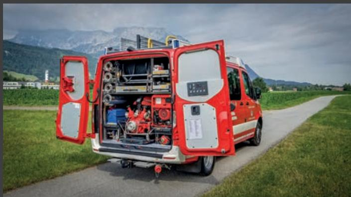
Das HLF1-W ist damit eines der ersten Feuerwehrfahrzeuge auf dem neuen Mercedes-Sprinter-Fahrgestell mit 190 PS. Besatzung 1:8.
